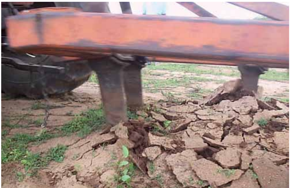
Foto 25 – Subsolador de Hastes Fixa, Máquina Usada na Conservação do Solo Fonte: João Bosco de Oliveira.
